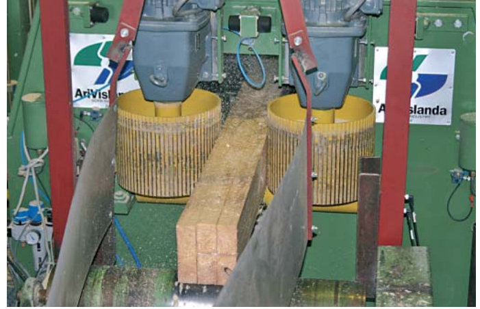
Mit dem Kreuzschnitt-Aggregat ist ein Einschnitt bis zu zehnstielig variabel möglich
